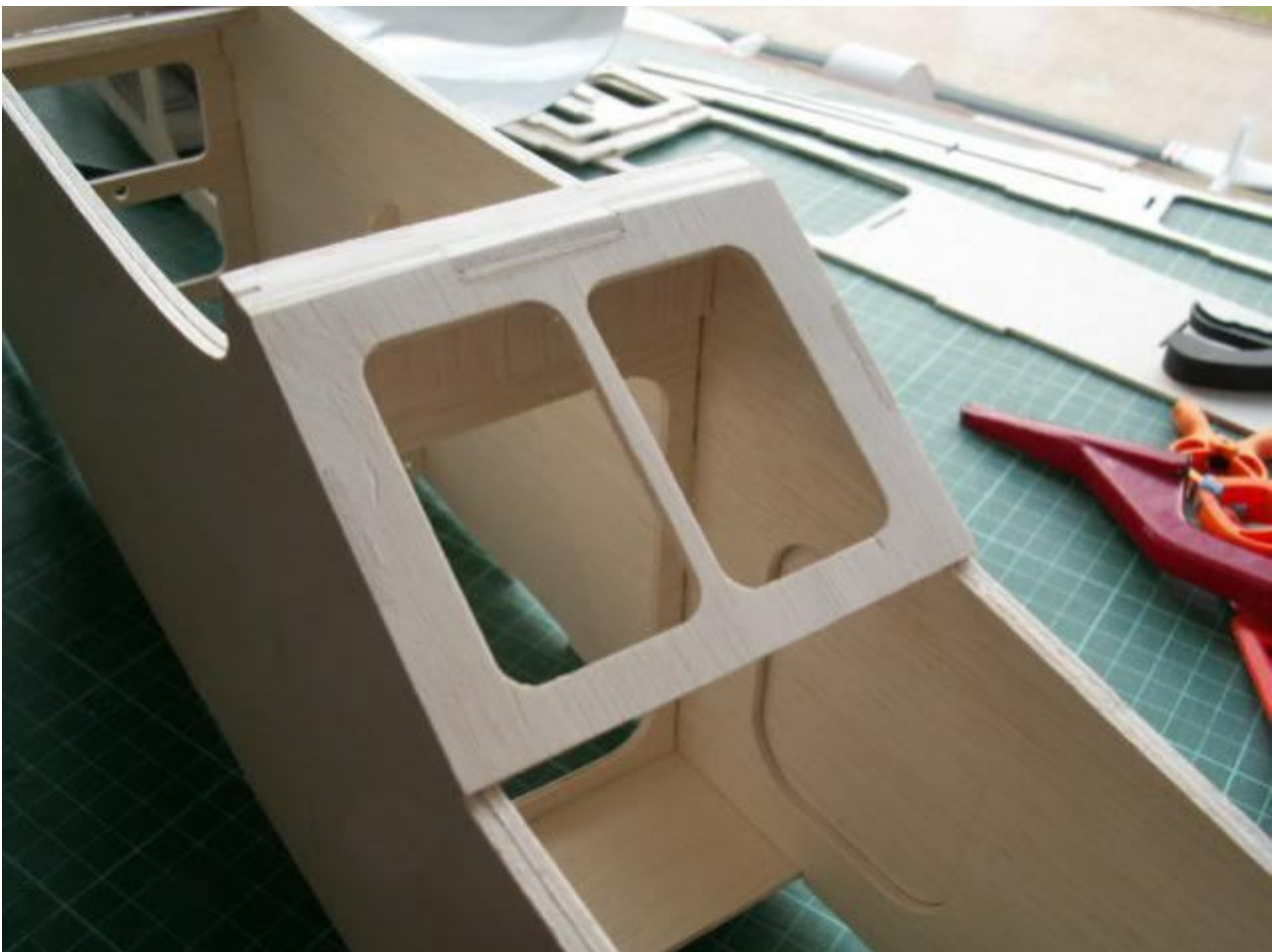
Resultaat na droogtijd en het te veel weg geschuurd met het schuurblokje .
