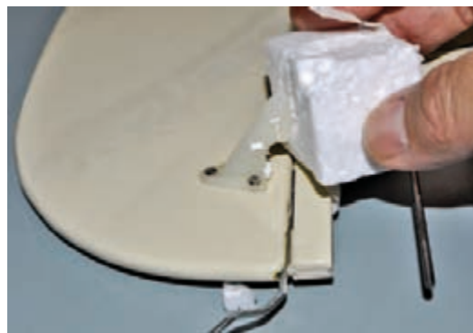
Selbst die bereits installierten Ruderhörner wurden zum Transport mit Styroklötzchen gesichert. So wird nichts verkratzt.
