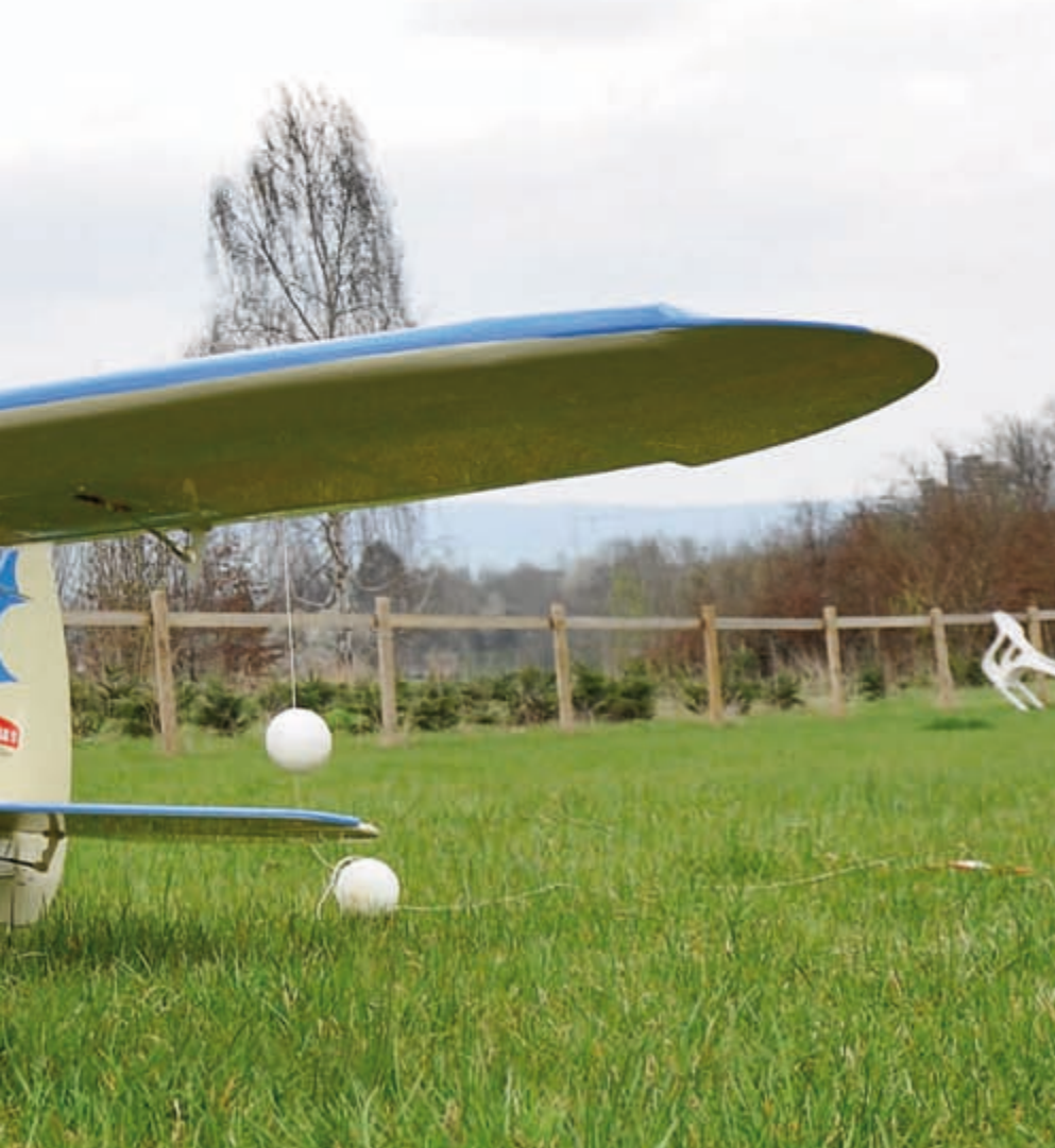
Selbst die bereits installierten Ruderhörner wurden zum Transport mit Styroklötzchen gesichert. So wird nichts verkratzt.
