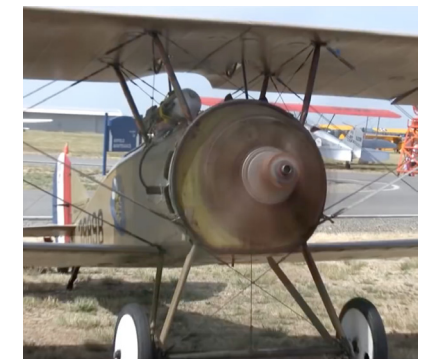
Een Amerikaanse Thomas Morse jager met zijn Le Rhône rotatiemotor op vol vermogen.
